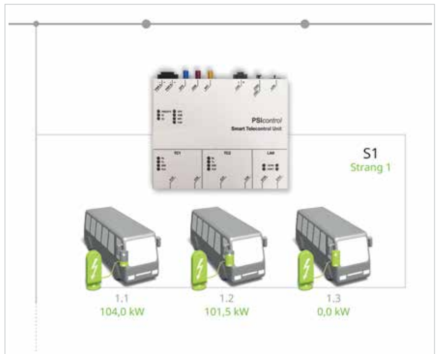
Ladesäulen- und Fahrzeugkommunikation mit der Smart Telecontrol Unit.
